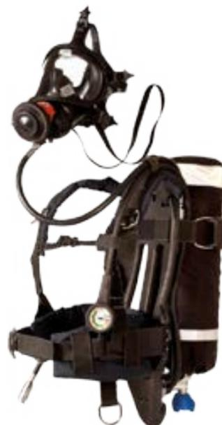
RN FR è un autorespiratore autonomo portatile di tipo 2 specificamente progettato per la lotta antincendio. RN FR unisce alla massima protezione e comfort l'efficienza e la semplicità d'uso. I materiali e le tecnologie utilizzate nei modelli FR sono di altissimo livello e tutti volti a rendere i componenti dell'autorespiratore altamente resistenti alla fiamma e in grado di resistere alla prova del Flash Over prevista dalla norma EN 137:2006.
